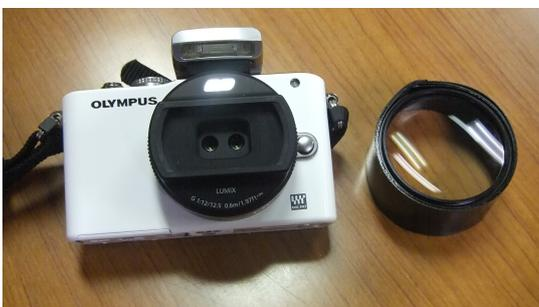
この接写レンズは3Dレンズの外径に合わせて作ったプラスチックの筒にはめた簡単なもので、これを装着するだけで、30cmぐらいまで接近して接写ができるそうです。
